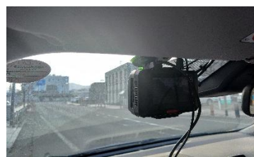
図 4, ドライブレコーダー型端末取付例
