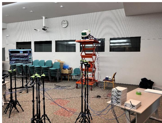
△当社製 5.7GHz 帯 WPT 装置と 日本工業大学のスケジューリングアルゴリズム受電評価
