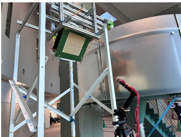
△当社製 24GHz 帯 WPT 装置と 金沢工業大学のレクテナレーによる受電評価
