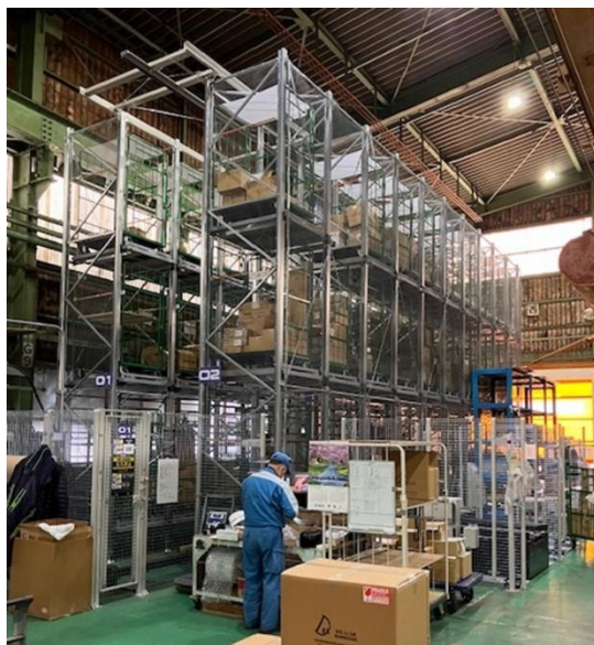
△新設した立体自動倉庫の全景
