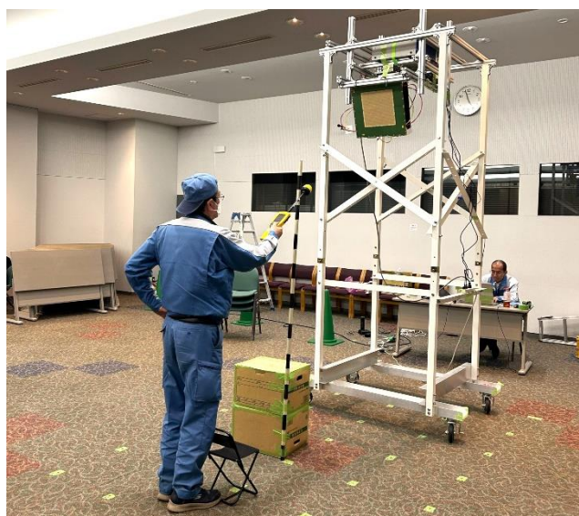
△電波暴露の評価測定(壁設置)
