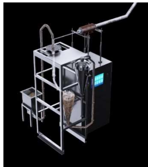
△サイクロン式の過熱蒸気反応装置（Rapid SPIRAL） 特許第 7063948 号
