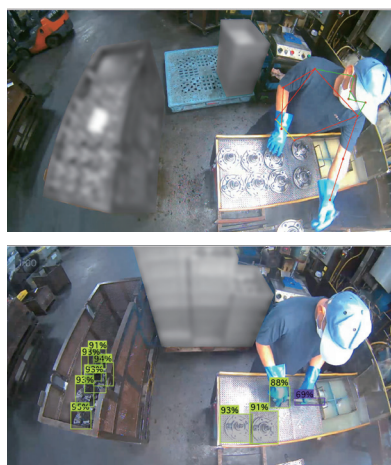
全方位から作業内容を撮影し、画像解析AIで定量的に計測・分析
