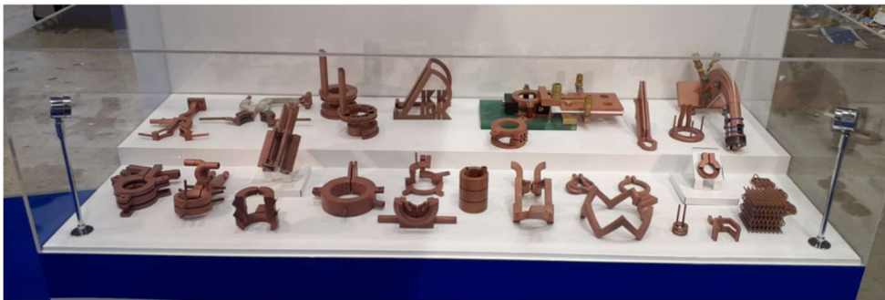
△展示予定の 3D プリントを使用した加熱コイル
