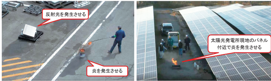
写真2 鹿沼工場および太陽光発電所における炎・反射光の実証実験
