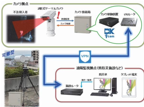
図2 人物検知システムの基本構成
