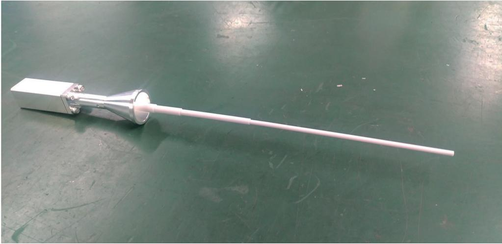
28GHz 帯階段形誘電体ロッドアンテナ(試作機)
