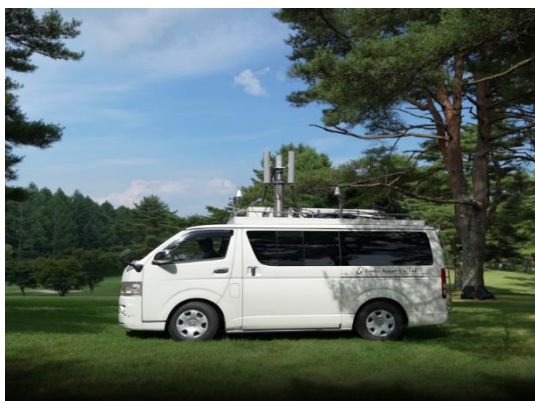
可搬基地局車（9 番・15 番ホール間に設置）
