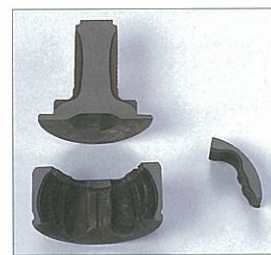
Hardened layer for BJ Outer-race BJアウターレース焼入硬化層
