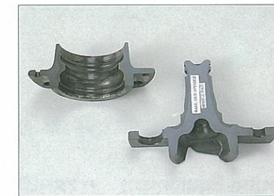
Hardened layer for Hub Unit Outer ring/Spindle HUB UNIT 外輪及びスピンドル 焼入硬化層
