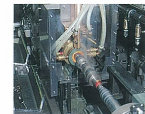
Camshaft single-shot NC hardening カムシャフト移動一発焼入
