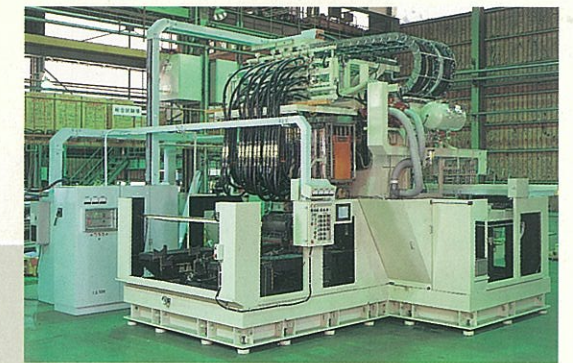
3 クランクシャフト焼入・焼戻機本体 Hardening & tempering machine
