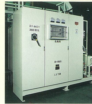
1 トランジスタインバーター (PTG型) Transistor Inverter (PTG Type) (Power:250kW, Frequency:20kHz)
