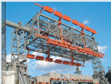
スキュー配置アンテナ(工場測定時)
