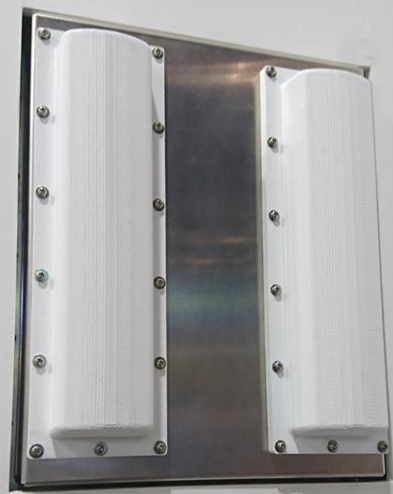
アンテナ一体型の28GHz帯無線装置
