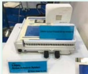
◀ 28GHz帯アクティブフェーズドアレイアンテナ (上) と 3.5GHz帯アクティブアンテナシステム (下)
