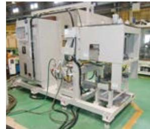
\* 通常はワーク(本設備の場合はガイドレールを指します)を固定してコイル側を移動させますが、本設備ではコイル側を固定してワークを移動させながら加熱することで、寸法の長いワークに対応しています。
