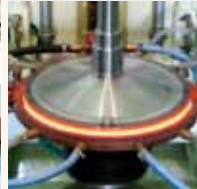
▼ クレーン用車輪焼入れの様子
