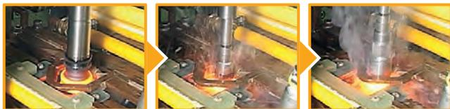
ロボットにより自動的に投入されたワークが下から上に押し上げられ、コイル径がワーク径の大きさに応じて自動的に変わること、最適な焼入れが行われます。当初は実験的な意味合いもあった当設備ですが、お客様の工場における実稼働を通じて、通常の設定と比べても遜色のない、優れた耐久性を持っていることが証明されています。作業効率を向上させ、汎用性も有した当社の技術は、お客様からも高い評価をいただいています。
