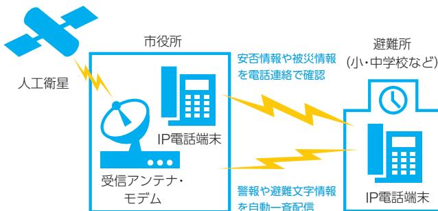
(図2) 5GHz 帯無線 LAN による防災ネットワークシステム
