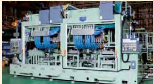
誘導加熱装置
