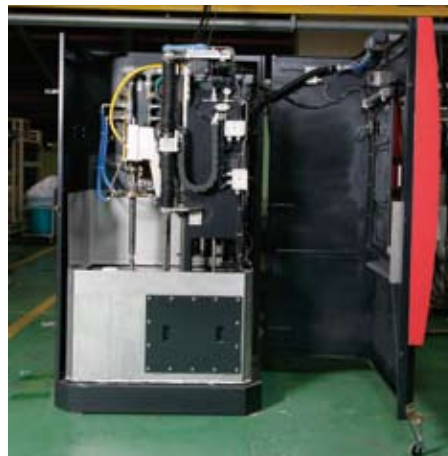
DENKO CUBO内部:誘導加熱装置を構成する各ユニットがコンパクトに配置されています。
