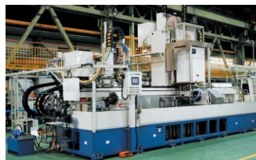
大型シャフト・チューブ焼入れ設備
