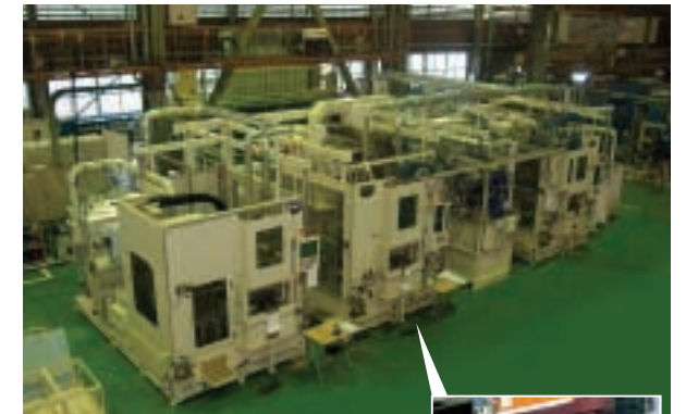
クランクシャフト焼入焼戻設備
